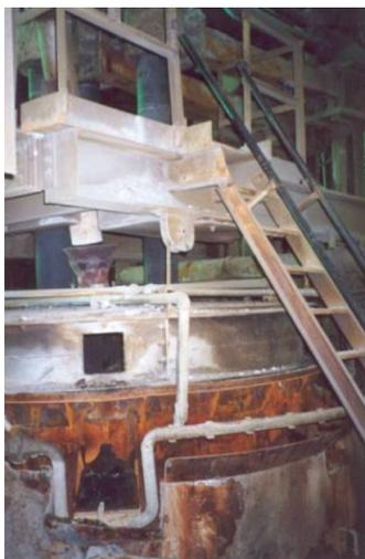
Figura 10 - Forno elétrico para a fabricação de fluxos fundidos
