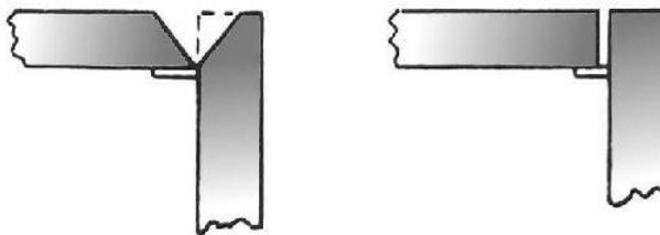
Figura 51 - Junta de canto com cobre-juntas
