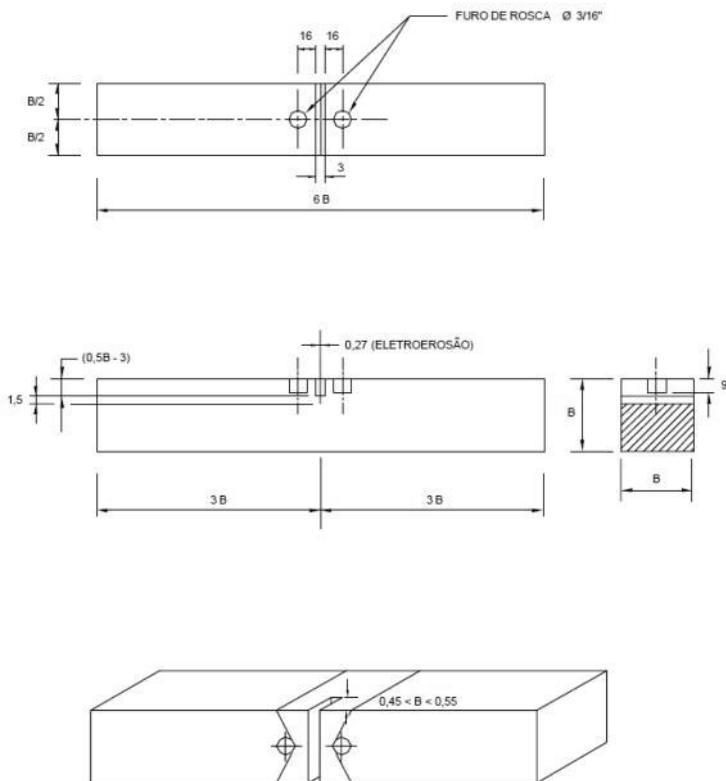
Figura 28 - Corpo de prova subsidiário [SE(B)]
