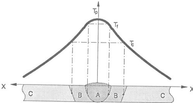
Figura 36 - Repartição térmica de uma solda
