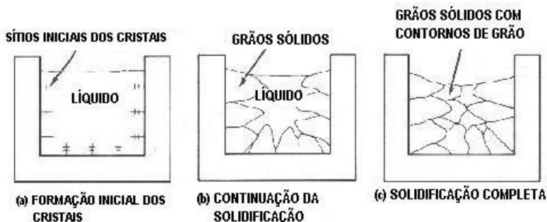
Figura 6 - Processo de solidificação dos metais
