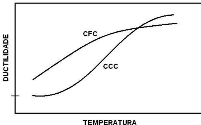
Figura 13 - Curvas de ductilidade em função da temperatura
