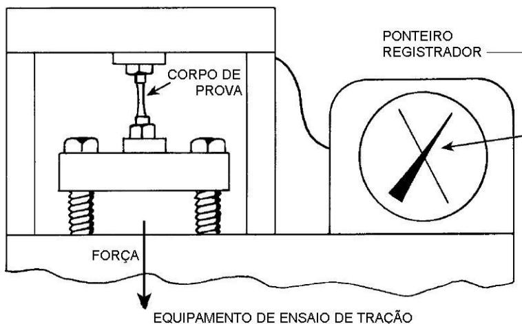
Figura 10 - Equipamento para ensaios de tração
