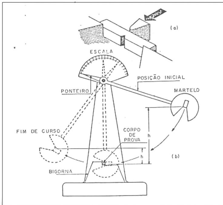
Figura 18 - Dispositivo de ensaio de impacto Charpy.
