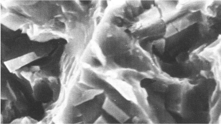
*Superfície de fratura de um corpo de prova de impacto Charpy-V tirado de um metal de solda de uma liga de níquel. A fratura está localizada no metal de solda próximo à linha de fusão (Svetsaren, vol. 47, No. 2, 1993, pp. 29).*
