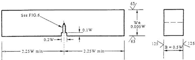
Figura 27 - Corpo de prova preferencial [SE(B)]
