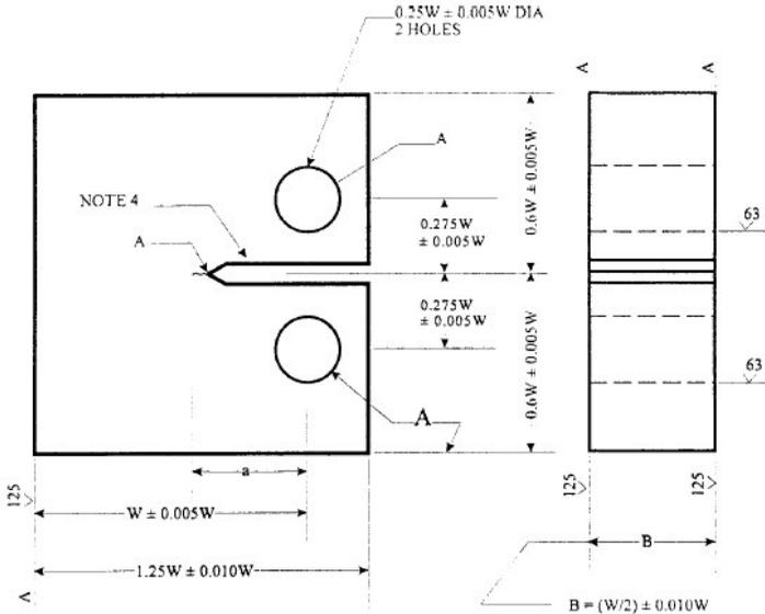
Figura 26 - Corpo de prova compacto [C(T)]
