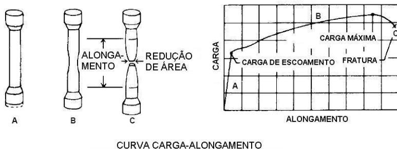
Figura 11 - Curva carga–alongamento
