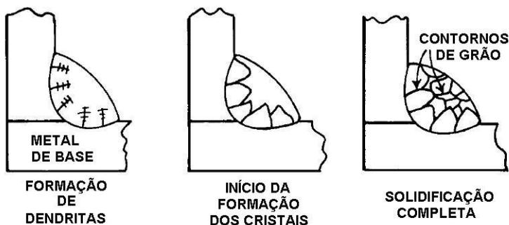
Figura 8 - Processo de solidificação de uma junta soldada
