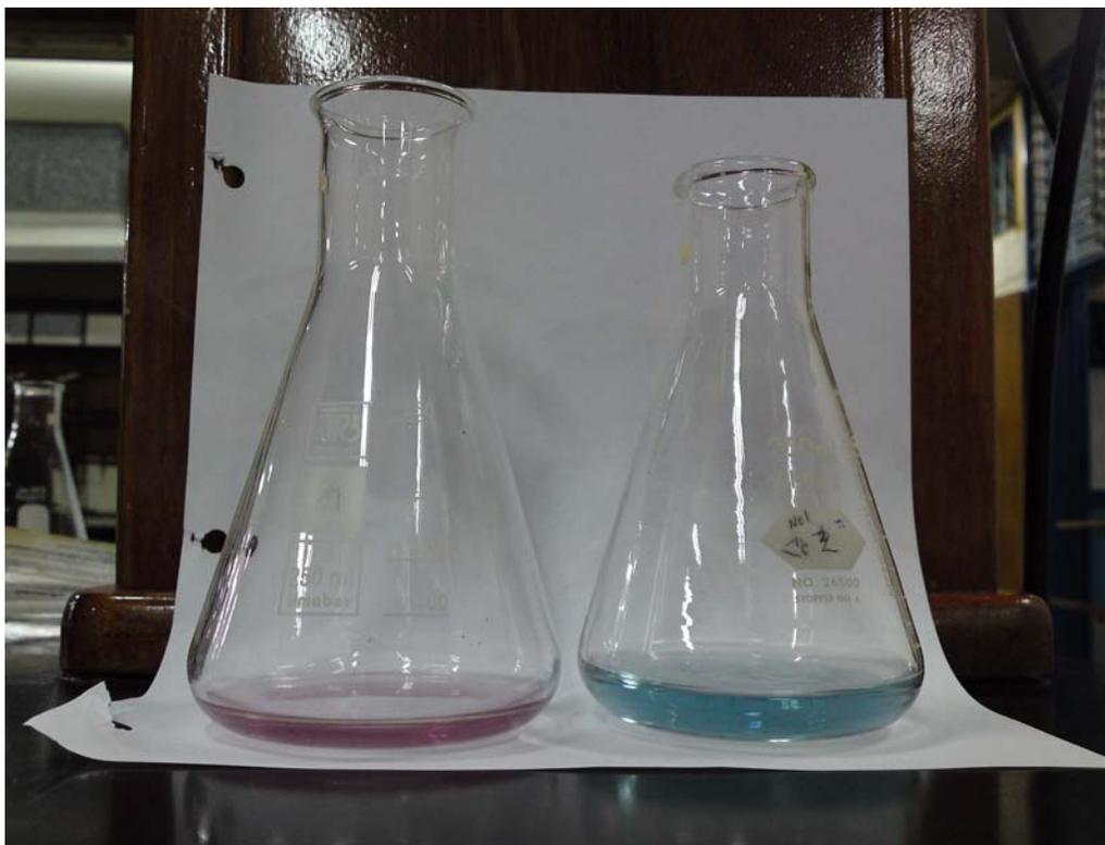
Figura 2. Coloración de la solución durante la titulación de la solución de EDTA con la solución de Carbonato de calcio. Izquierda) antes del punto de equivalencia. Derecha) después del punto de equivalencia
